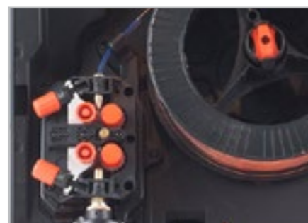
Modele Kempact 253/323 posiadają 4-rolkowy mechanizm podający DuraTorque.
