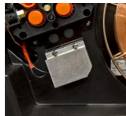
UKŁAD OGRZEWANIA KOMORY SZPULI KWF 200/300
