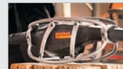
Solidna stalowa rama skutecznie chroni go przed typowymi zagrożeniami miejsca pracy, takimi jak uderzenia czy zgniecenia.
