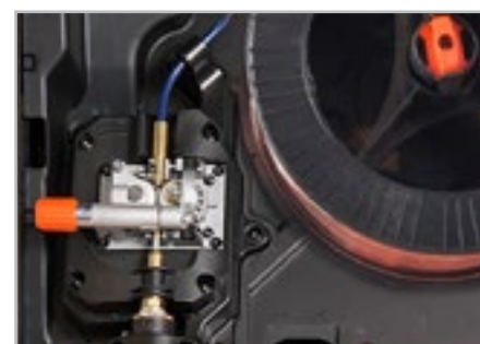
Modele Kempact 181/251 posiadają 2-rolkowy mechanizm podający GT02C.
