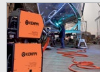
Tradycyjne uchwyty typu push-pull i uchwyty z własną szpulą mocno obciążają nadgarstek spawacza, a dodatkowo nakładają istotne ograniczenia co do zasięgu, rodzaju drutu i intensywności eksploatacji. Podajnik pośredni SuperSnake GT02S rozwiązuje wszystkie te problemy bez obciążania nadgarstka spawacza poprzez możliwość korzystania ze standardowych uchwytów.
